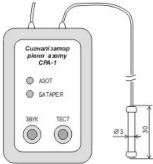
При достижении уровнем азота критического значения, генерируются сигналы тревоги (звуковой и световой). При необходимости звуковой сигнал отключается.
